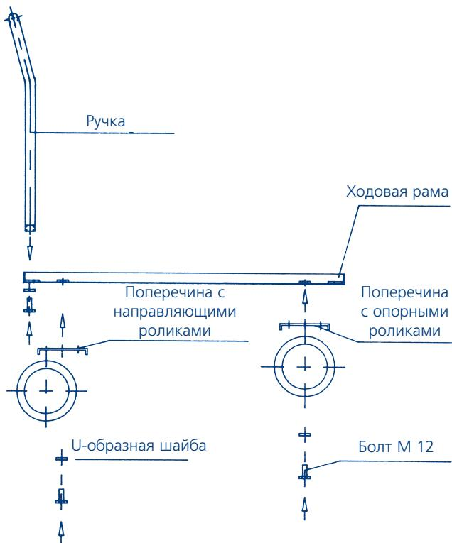
После этого платформенная тележка готова к эксплуатации.
