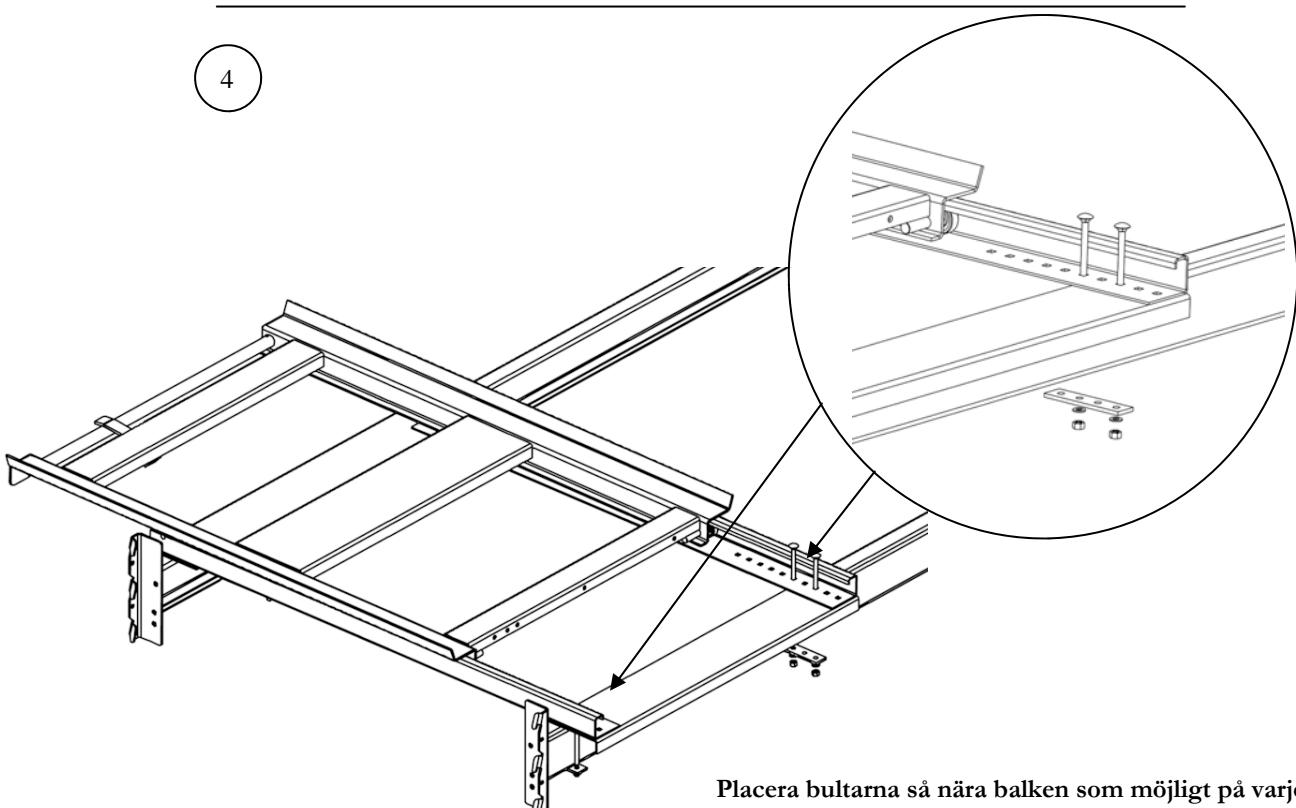
Placera bultarna så nära balken som möjligt på varje sida. Montera fästskena, brickor och muttrar på bågge sidor.
